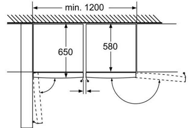
Schalen voll herausziehbar wenn das Gerät direkt an einer Wand platziert ist.
