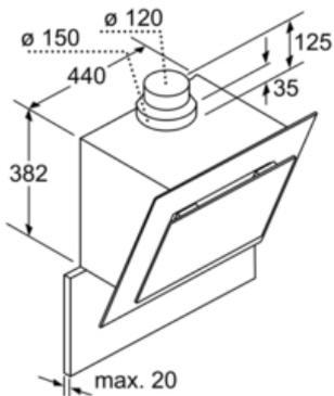
Bei Verwendung einer Rückwand muss das Design des Gerätes beachtet werden.
